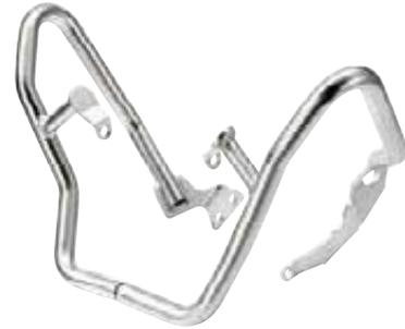
Die Motorschutzbügel aus Edelstahl schützen das Motorrad vor Beschädigung, ohne die Schräglagenfreiheit einzuschränken.
