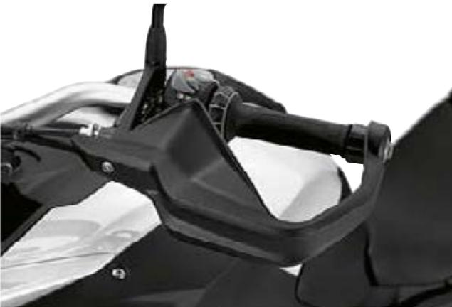
Der Handschutz aus schlagfestem und UV-beständigem Kunststoff schützt im Gelände auch die Bedienelemente vor Ästen und Steinschlag. Auf der Straße überzeugt zudem der Wind- und Wetterschutz der Protektoren: Hände und Finger bleiben auch bei niedrigen Temperaturen länger trocken und warm.
