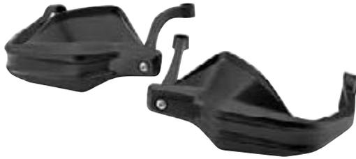
Der Handschutz aus schlagfestem und UV-beständigem Kunststoff schützt im Gelände auch die Bedienelemente vor Ästen und Steinschlag und ist aerodynamisch auf das Fahrzeug abgestimmt. Auf der Straße überzeugt zudem der Wind- und Wetter-Schutz der Protektoren: Hände und Finger bleiben auch bei niedrigen Temperaturen länger trocken und warm.
