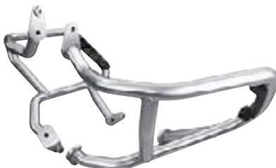
Der robuste Motorschutzbügel aus poliertem Edelstahl schützt den Bereich des Zylinders zuverlässig vor Beschädigung, ohne die Schräglagenfreiheit einzuschränken. Die stabile Rohrkonstruktion verkräftet selbst derbe Schläge und kann kapitale Sturzschiäden auf Asphalt verhindern.
