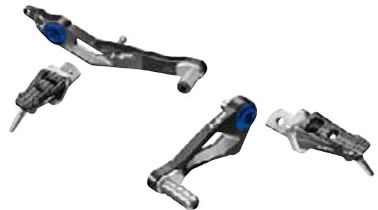
Die HP Fahrerfußrasten sind in drei Positionen einstellbar und bieten neben ergonomischen Qualitäten ein Höchstmaß an Komfort. Die hochwertigen Frästeile aus eloxiertem Aluminium lassen sich an eine sportliche Fahrweise oder unterschiedliche Fahrerstaturen anpassen und gewährleisten so eine noch bessere Kontrolle etwa in Schräglage.
