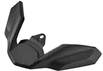
Die größere Vorderradabdeckung betont die Enduro-Eigenschaften der BMW R 1250 GS und bietet gleichzeitig mehr Spritzschutz.
