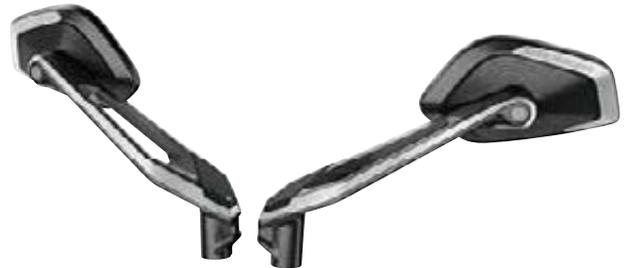
Die hochwertigen HP Spiegel sind aus gefrästem Aluminium gefertigt und unterstreichen den sportlichen Charakter der Maschine. Die vibrationsarme Auslegung und die aerodynamische Formgebung gewährleisten eine hervorragende Sicht. Das ansprechende Design inklusive BMW Motorrad Schriftzug erzeugt zugleich einen starken Individualisierungseffekt.
