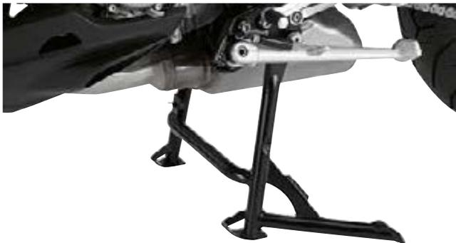
Der stabile Hauptständer sorgt für einen sicheren Stand der Maschine auch in Hanglagen und bietet Vorteile etwa beim Tanken, bei der Montage von Koffern und Topcase oder bei der Reifendruckkontrolle. Außerdem benötigt die aufrecht geparkte Maschine weniger Raum.
