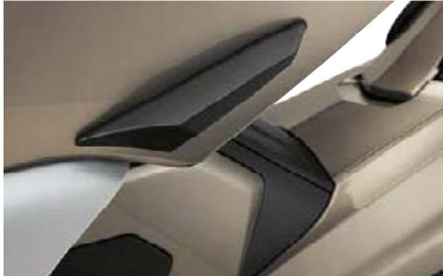
Die Sturzpads aus robustem Kunststoff schützen den Scooter im Fall des Falles vor Beschädigung. Die abriebfesten Pads werden vorn an die Verkleidung und hinten an die Trittbretter geschraubt und bieten einen effektiven Schutz bei Umfallen oder Stürzen bei geringer Geschwindigkeit.
