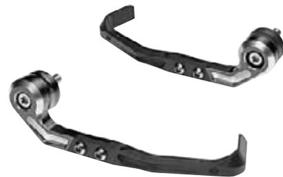
Der Kupplungshebelprotektor setzt ein klares Statement in Sachen kompromisslose Sportlichkeit. Der gebogene Bügel aus Aluminium und Kunststoff schützt den Kupplungshebel am Lenker davor, bei Berührung mit einem anderen Fahrzeug unbeabsichtigt betätigt oder bei einem Umfallen der Maschine beschädigt zu werden.
