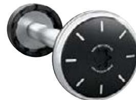
Die gefräste Hinterachsabdeckung aus Aluminium betont das dynamische Design des Fahrzeugs. Die schwarz eloxierten Abdeckungen mit BMW Motorrad Schriftzug und einem Durchmesser von 62 mm werten die Maschine optisch und technisch auf.
