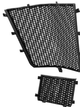
Das Kühlerschutzgitter von BMW Motorrad schützt den Kühler auf der Rennstrecke zuverlässig vor Reifenabrieb und Beschädigungen durch Steinschlag. Das zweiteilige Gitter aus Polyamid ist passgenau für den oberen Wasserkühler und den unteren Ölkühler gefertigt und passt sich durch seine Bauform perfekt an die Aerodynamik des Motorrads an.
