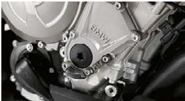
Der HP Motorprotector bietet mit seinen auswechselbaren Kunststoff-Schleifpads verbesserten Schutz vor Beschädigung von Motorbauteilen.
