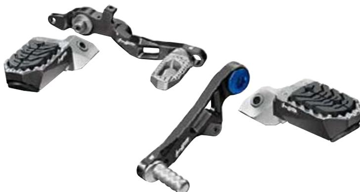
Die HP Fahrerfußrasten mit Trittplatten aus Kunststoff sind einstellbar und bieten on- wie offroad ein Höchstmaß an Komfort und Trittsicherheit. Die hochwertigen Frästeile aus eloxiertem Aluminium bieten besonders beim Fahren im Stehen mehr Kontrolle. Die exklusive Optik mit HP Logo unterstreicht den performanceorientierten Charakter der Maschine.
