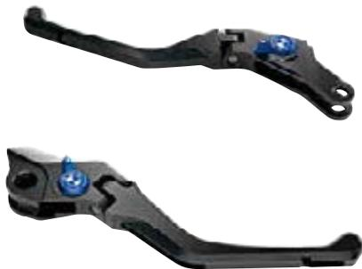
Der Handbremshebel ist für die bevorzugte Griffweite fünffach einstellbar und dank Klappmechanismus mit einem definierten Einklappmoment versehen.
