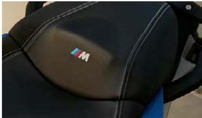
Der M Fahrersitz Sport mit rutschhemmendem Bezug bietet mehr Halt und unterstützt eine sportlich orientierte Fahrweise. Die homogene Druckverteilung auf dem PU-Schaumkörper verschafft auch dem Beifahrer einen langstreckentauglichen Sitzkomfort. Abgerundet wird die sportliche Optik durch ein kleines M Logo.
