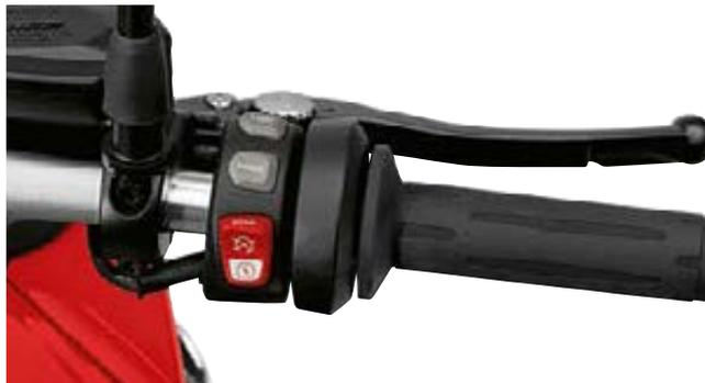
Komfort trifft Sicherheit. Mit den praktischen Heizgriffen bleiben die Hände auch an kalten Tagen immer angenehm warm und sind gleichzeitig reaktionsbereiter. Die vom Bordcomputer gesteuerte Griffheizung erfasst über Sensoren kontinuierlich die Außentemperatur und passt die Wärmeabgabe an.
