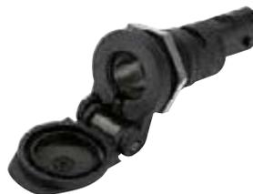
Über die nachrüstbare 12-Volt-Steckdose lassen sich elektronische Geräte an das Bordnetz des Fahrzeugs anschließen. Ein Beispiel dafür ist das BMW USB Ladegerät, an dem etwa Mobiltelefone und MP3-Player mit entsprechender Schnittstelle auch während der Fahrt aufgeladen und betrieben werden können.
