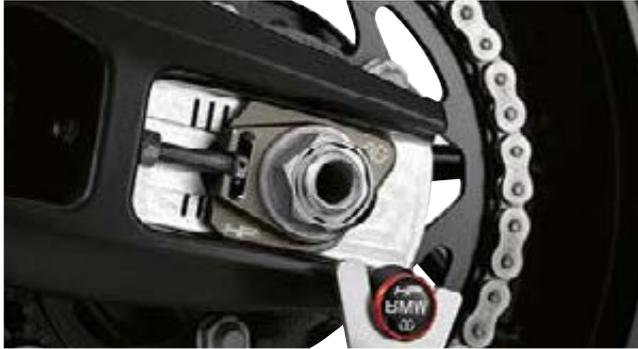
Der HP Kettenspanner ermöglicht die hochpräzise Einstellung von Kettenspannung und der Hinterradausrichtung. Gleichzeitig erleichtert er den Einbau des Hinterrads, da er fest mit der Schwinge verbunden bleibt.
