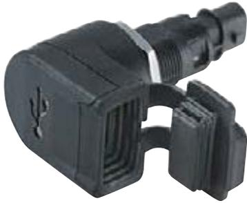
Die Ladesteckdose mit 12-Volt-Spannung erlaubt die Versorgung von externen Stromverbrauchern. Mithilfe des BMW USB-Ladegeräts können beispielsweise externe Navigationsgeräte, Musikplayer oder Mobiltelefone auch während der Fahrt mit Strom versorgt bzw. geladen werden.
