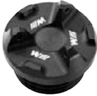
Der M Öleinfüllstutzen aus schwarz eloxiertem Aluminium mit weiß eingelasertem M Logo setzt mit seiner Optik einen sportlichen Akzent. Der Verschlussdeckel ist mit drei Bohrungen versehen, die eine Aufdrehsicherung für die Rennstrecke gewährleisten.
