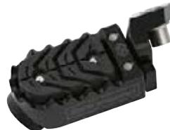
Die gefederten Fahrerfußrasten mit Trittplatte aus Kunststoff sind in drei Positionen einstellbar und bieten on- wie offroad ein Höchstmaß an Komfort und Trittsicherheit. Das bedeutet besonders im Gelände zusätzlichen Halt und eine noch bessere Kontrolle der Maschine beim Fahren im Stehen.
